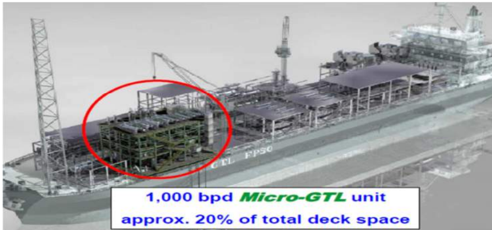
Figure 1.35 A floating Mini GTL technology.
